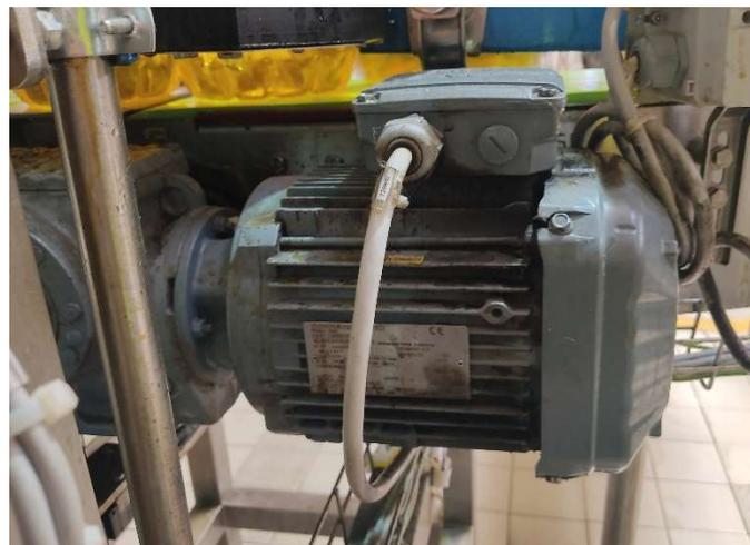
Figure I. 9 Moteur asynchrone triphasé.
