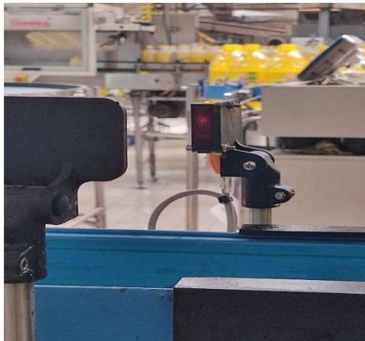
Figure I. 7 Capteur de distance laser.
