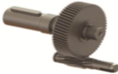
**Figure II-5** : roue cylindrique.
