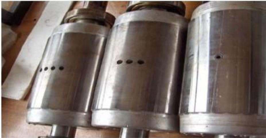
**Figure 1.10** : Ruptures de barres
