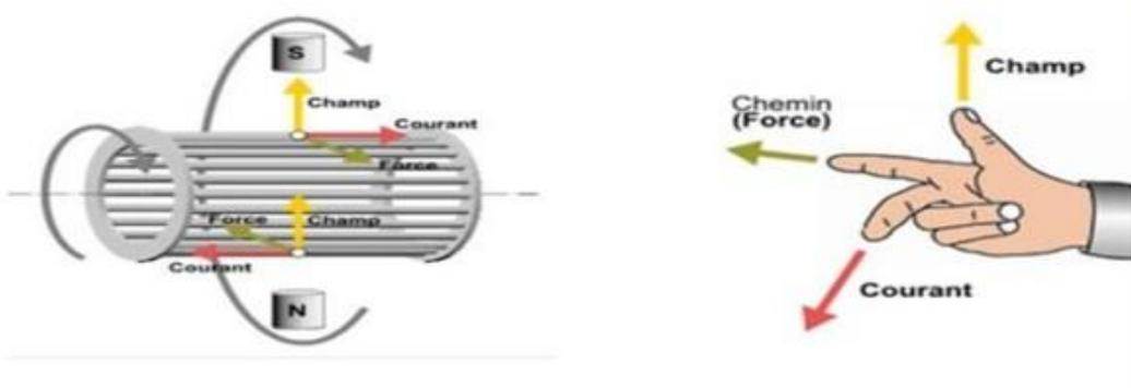
Figure 1.5 : Principe de fonctionnement de machine asynchrone
