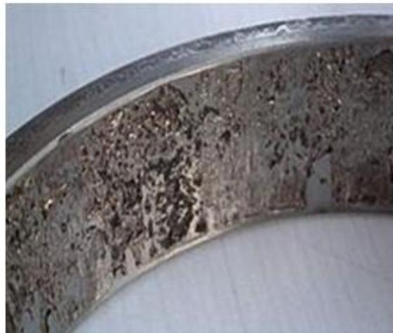
**Figure 1.12:** défauts des roulements
