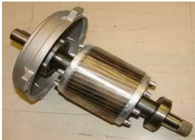
Figure I-14 rotor a cage d'écureuil. [28]
