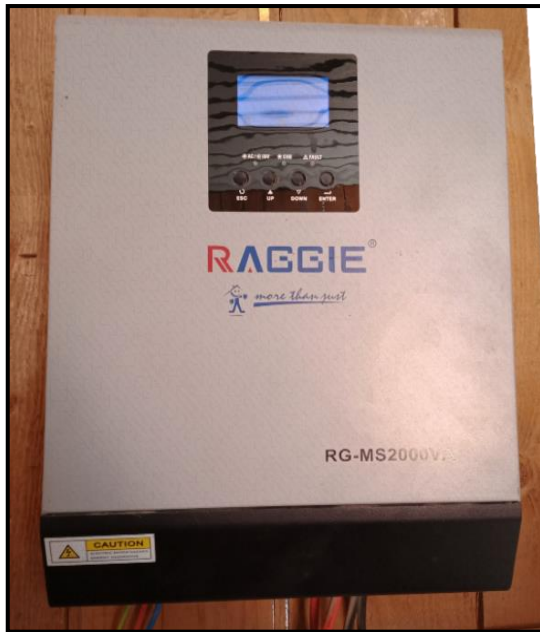
Figure IV.7 : L'onduleur de 2KW insérée dans l'installation PV et sa fiche technique. [65]
