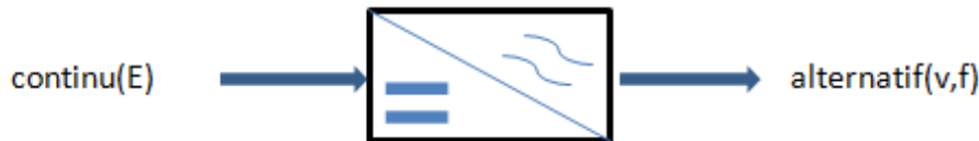
Figure (II.10) : schéma bloc représentatif d'un onduleur.
