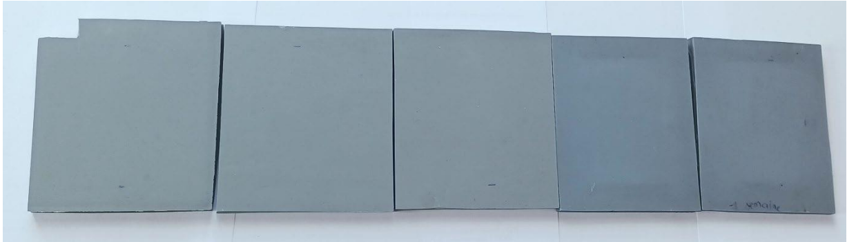
Fig. IV.37 Observation visuelle de la décoloration des échantillons après vieillissement au UV et a la température
