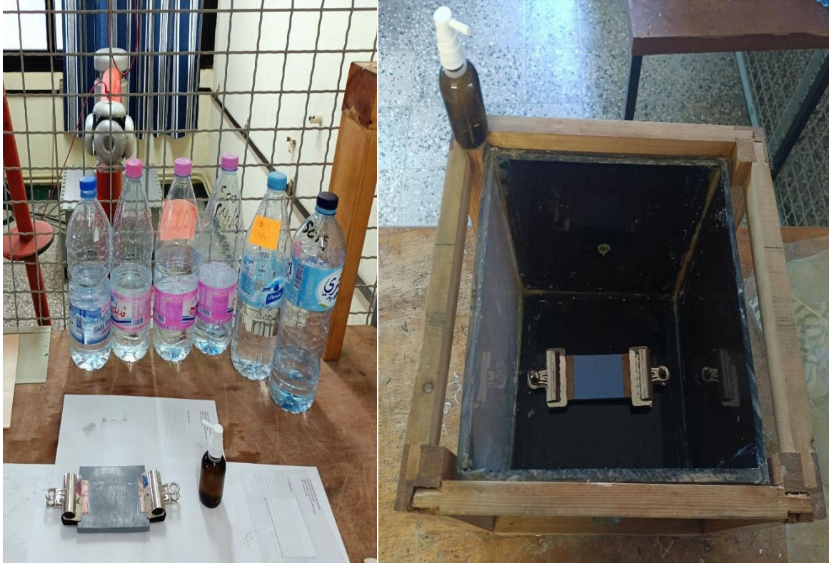
Fig.25 Dispositif expérimentale pour la reproduction de la pollution artificielle
