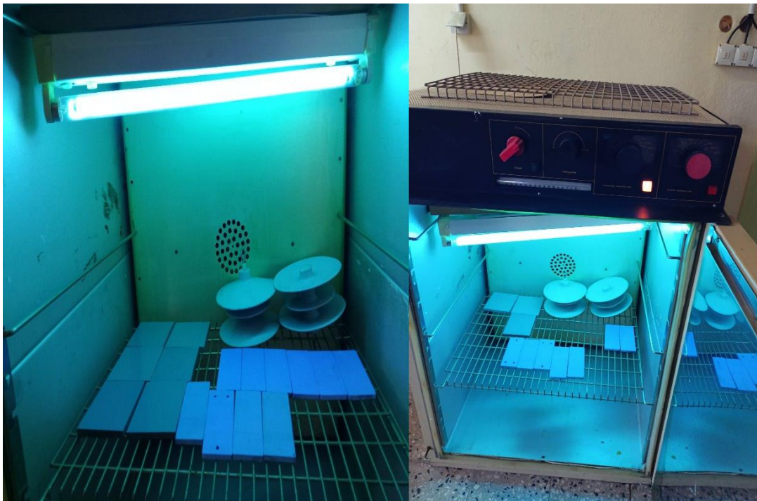
Fig.23 Cellule de vieillissement sous UV et température
