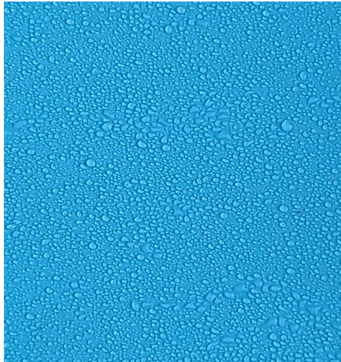
Fig.26 Répartition de la pollution sur la surface de l'isolateur silicone obtenue par pulvérisation
