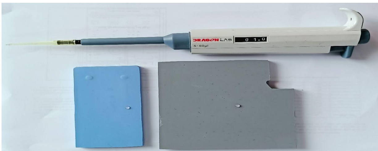
Fig .33 Micropipette utilisée pour doser et disposer la goutte d'eau sur la surface de la silicone
