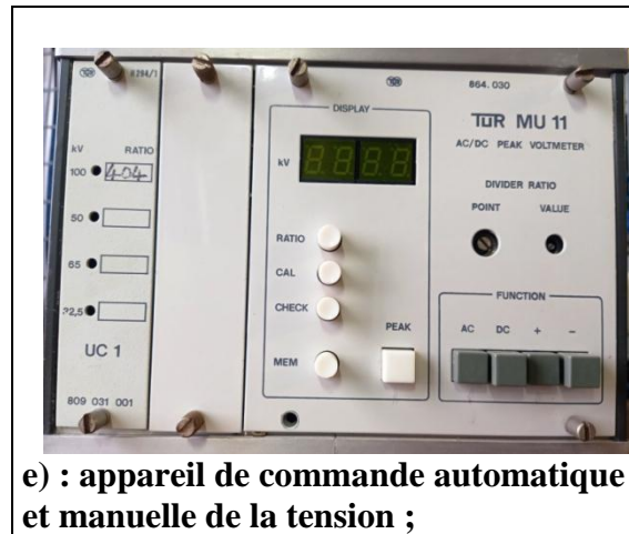
Figure III-7 Photos des éléments du dispositif d'essais et de mesure de la haute tension du laboratoire HT G.E. Université de Bejaïa.
