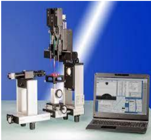
Figure II-7 appareil de mesure de l'angle de contact Figure II-8 La méthode de détermination de l'angle de contact.
