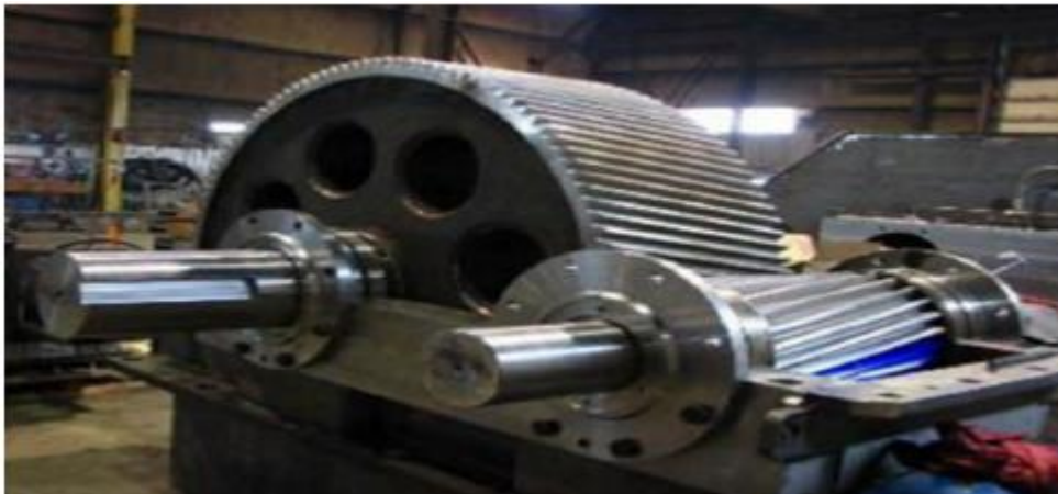
Figure I. 4 : Structure générale du réducteur à arbres parallèles.
