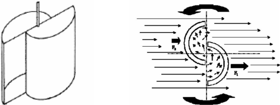
**Figure I. 16: Turbine Savonius simple et son Principe de fonctionnement**
