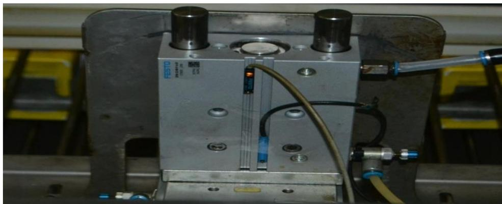
Figure II.15 Vue d'un vérin de guidage du notre convoyeur
