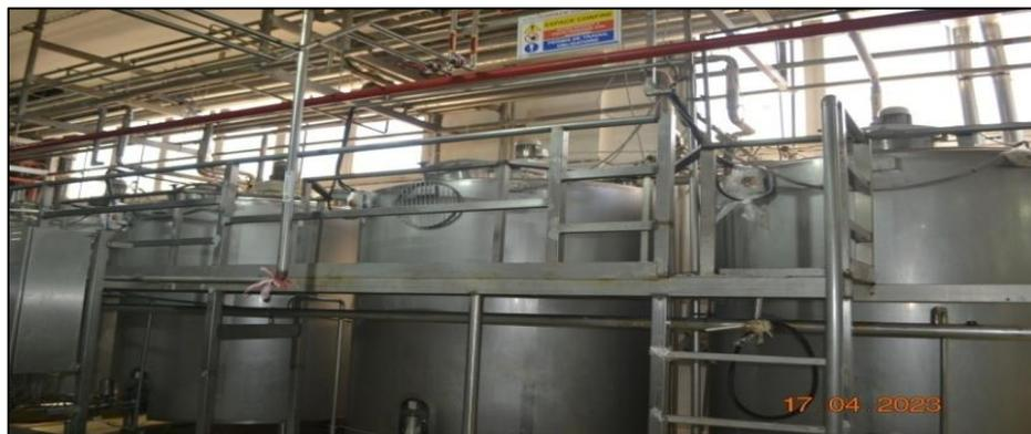
Figure I.4 Cuves de préparation d'émulsion
