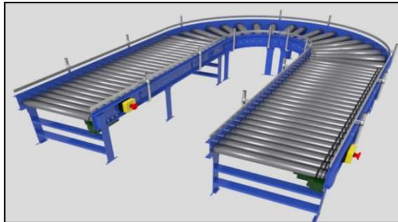
Figure II.7 Convoyeur a rouleaux [5]
