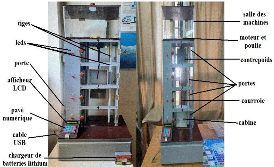
Figure III. 29: Ascenseur à base d'Arduino
