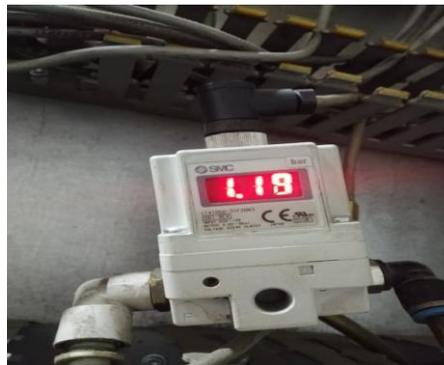
*Figure II.9 : régulateur de pression*
