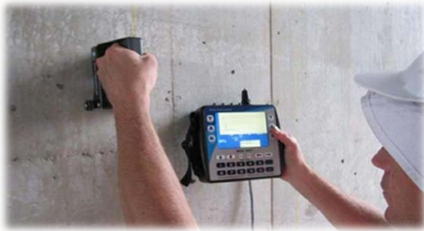
Figure 12 : Test Choc-Echo avec appareil Olson's NDE 360.[7]
