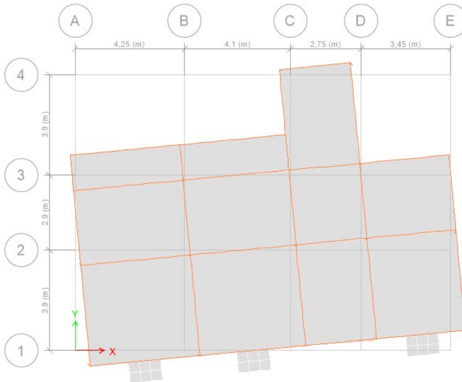
Figure 11: 3ème mode de vibration T= 0,384 sec (Rotation selon Z-Z)
