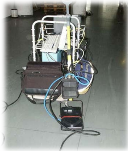
Figure 18: Équipement radar utilisé pour détection d'armatures [8]
