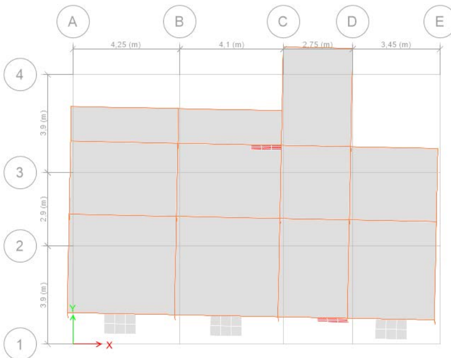
Figure 10 : 2 ème mode de vibration (translation suivant Y Avec T=0,472 sec)
