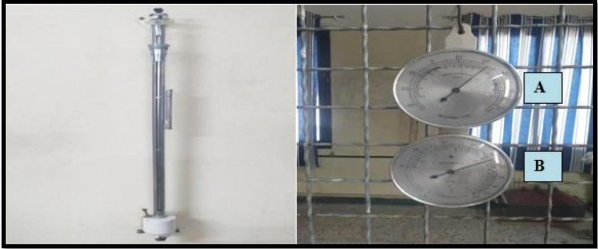
**Figure II.9 :** Baromètre.
