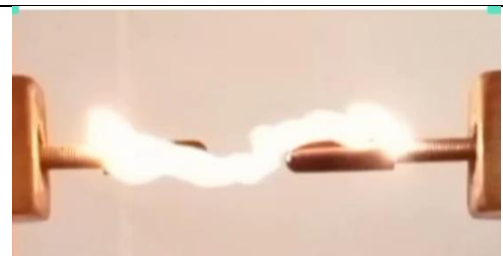
Fig. III. 24 : Système pointe - pointe avec deux barrières superhydrophobes ( l_b=5\text{cm} )
