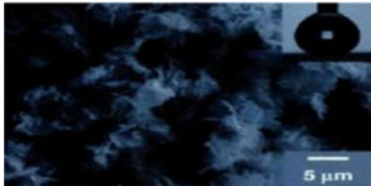
Fig. I. 12 : Film d'argent sur du cuivre
