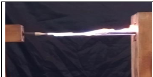
Fig. III. 17 : Système pointe - pointe avec une barrière polluée (lb = 10 cm)
