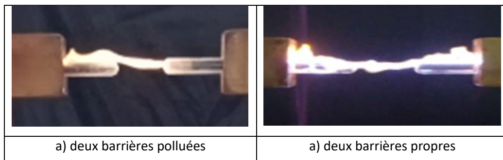
Fig. III. 19 : Système pointe - pointe avec deux barrières ( l_b=5 \text{ cm} )
