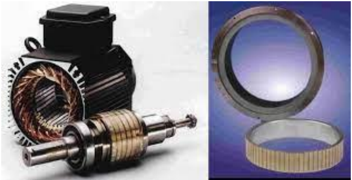
Figure I. 4: Structure générale de la machine synchrone à aimants permanents.
