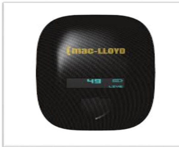
Figure n°09 : Traquer STv4 ; GPS et accéléromètre de référence
