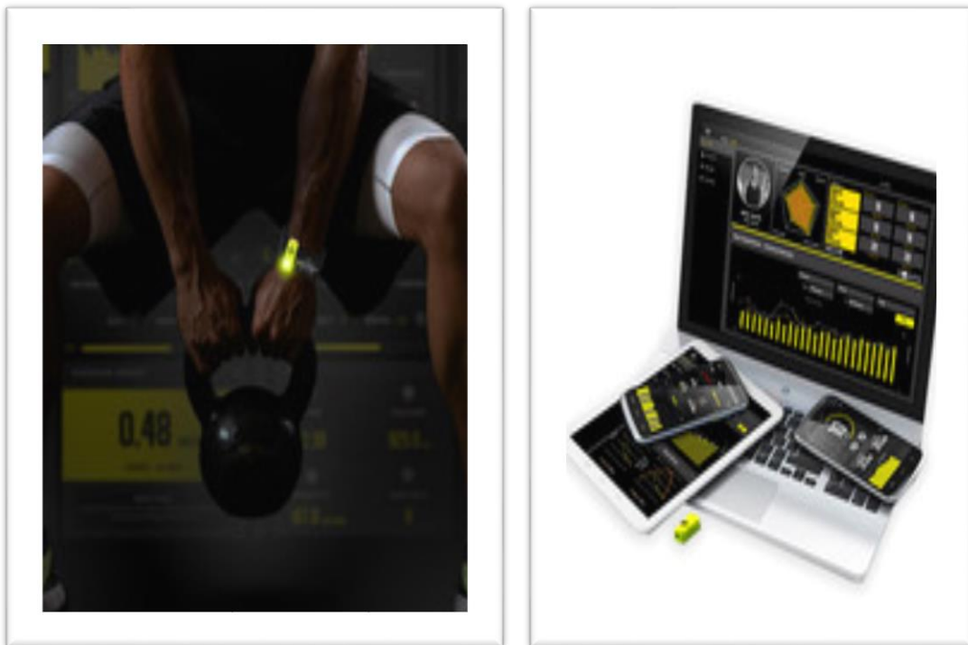
Figure n°23 : BEAST – capteur de puissance musculaire sans fil
