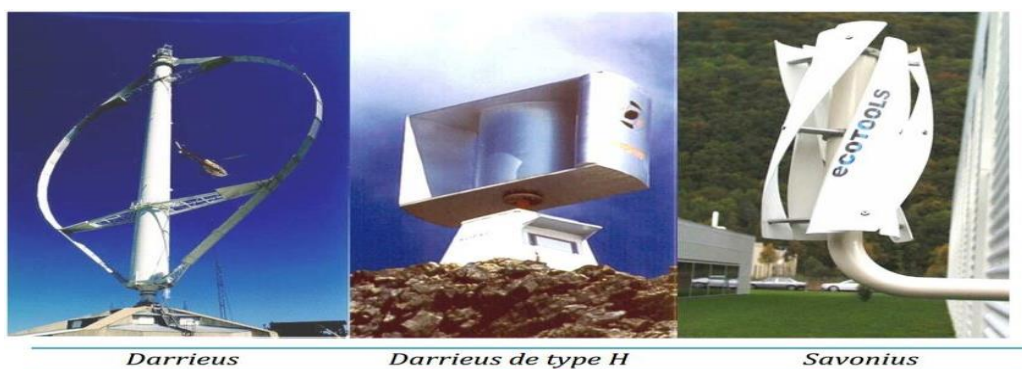
Fig.I.4 Éolienne à axe verticale : turbine Darrieus, turbine Darries de type H et turbine Savonius
