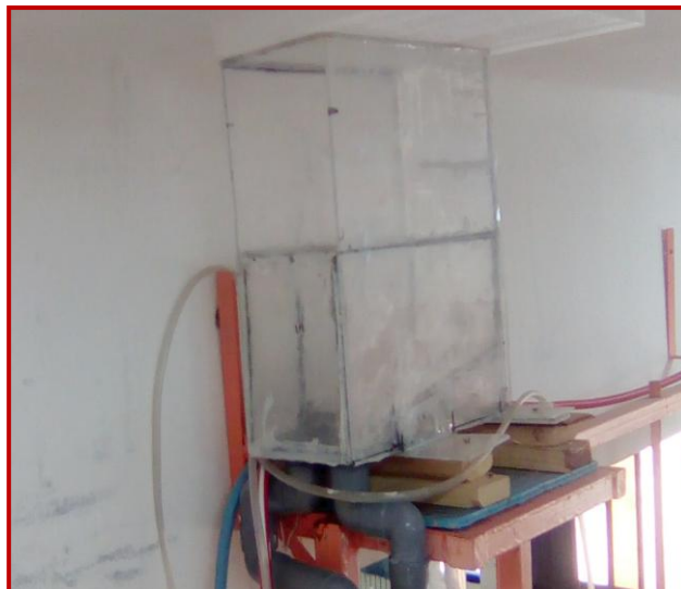
Figure III.7: Séparateur de phases
