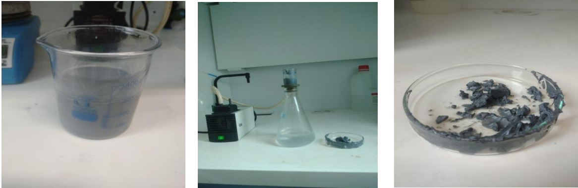
Figure 19 : Expérience de préparation d'une pâte ZnO/Graphène
