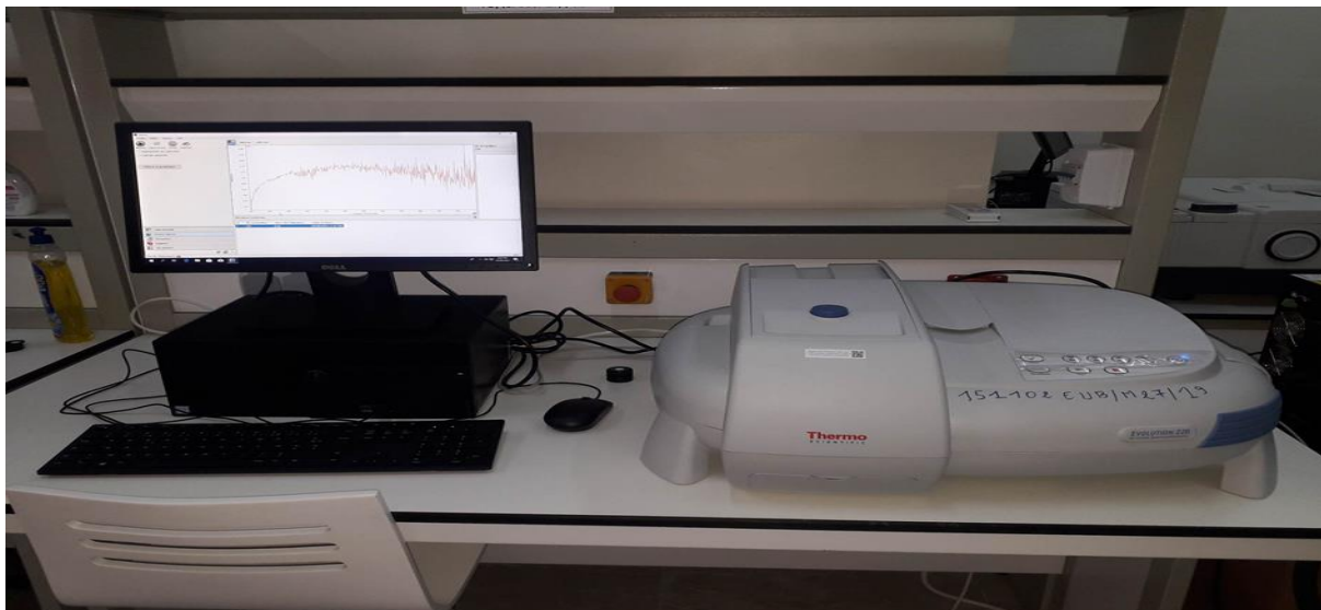
Figure 28 : Spectrophotomètre UV-Visible solide.
