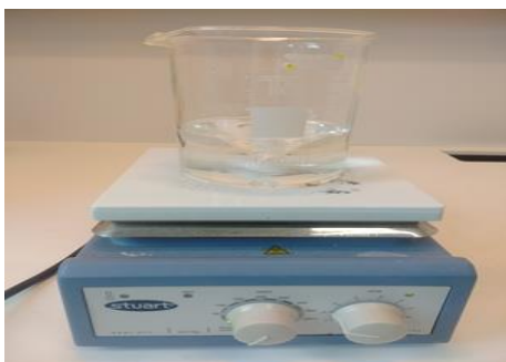
Figure 14 : Dissolution d'une masse 9,1g de Zinc Sulfate heptahydrate ( \text{ZnSO}_4 \cdot 7\text{H}_2\text{O} )
