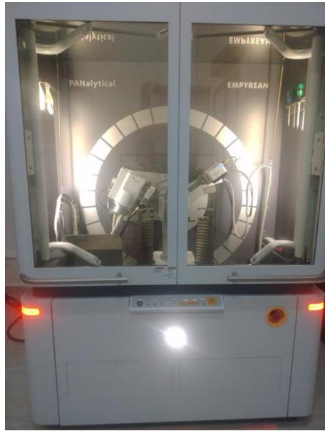
Figure 27: Photographie de la machine de DRX.
