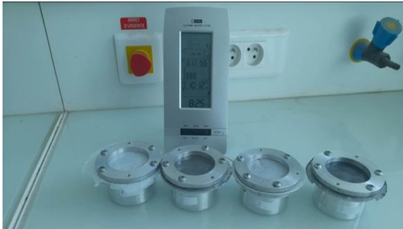
Figure 29 : Test de perméabilité d'eau pour les nano composites.
