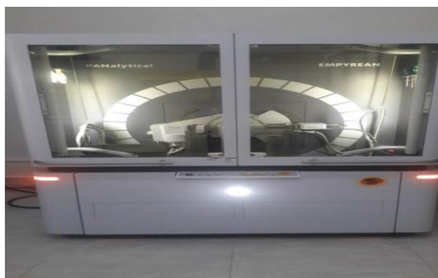
**Figure IV.4 :** Le diffractomètre à rayon X.
