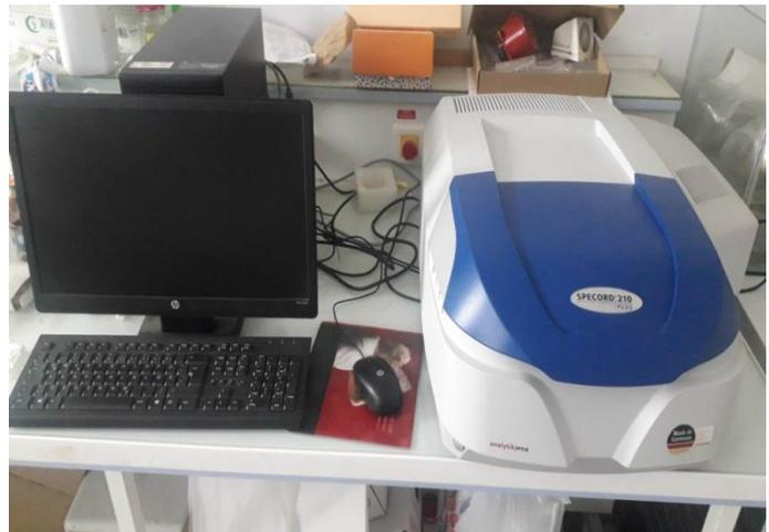
**Figure V.3 :** Spectrophotomètre UV-Visible.
