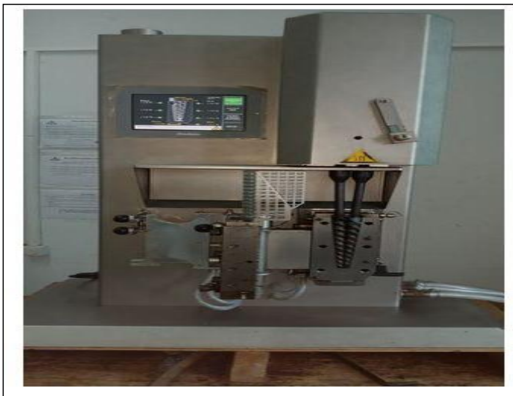
Figure III.4: Représentation de l'extrudeuse bi-vis.
