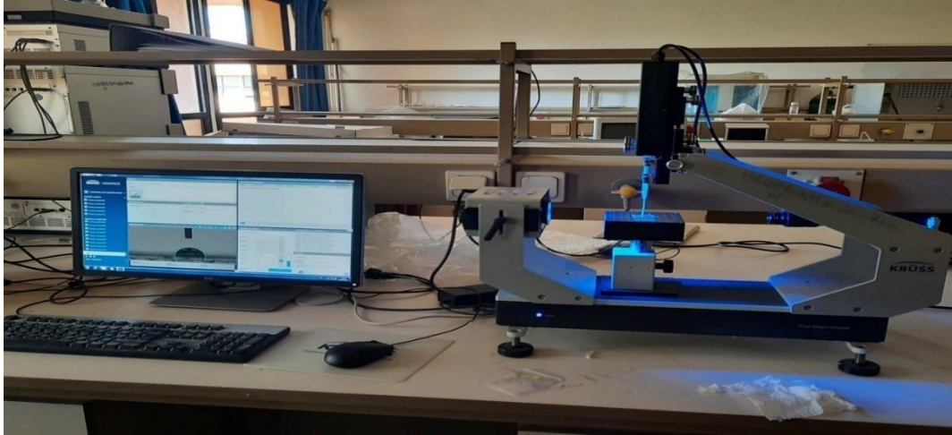
Figure III.14: Appareillage de mesure d'angle de contact «KRUSS».
