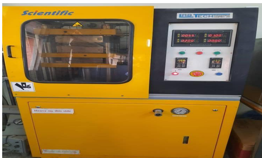
Figure III.6: Photographie d'une presse hydraulique.
