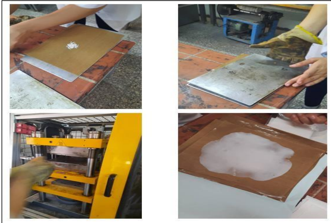
Figure III.7: Préparation des films par la presse hydraulique.
