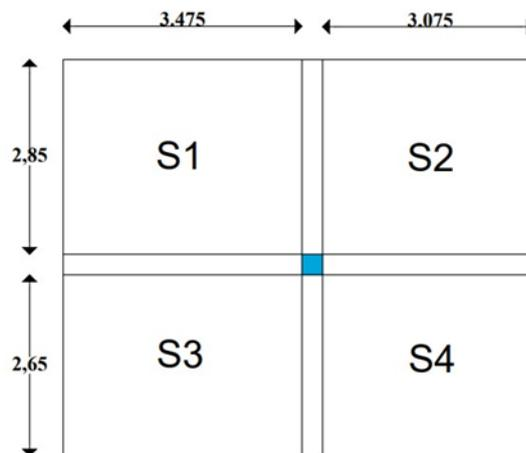
**Figure II.10.** La surface afférente du poteau C2
