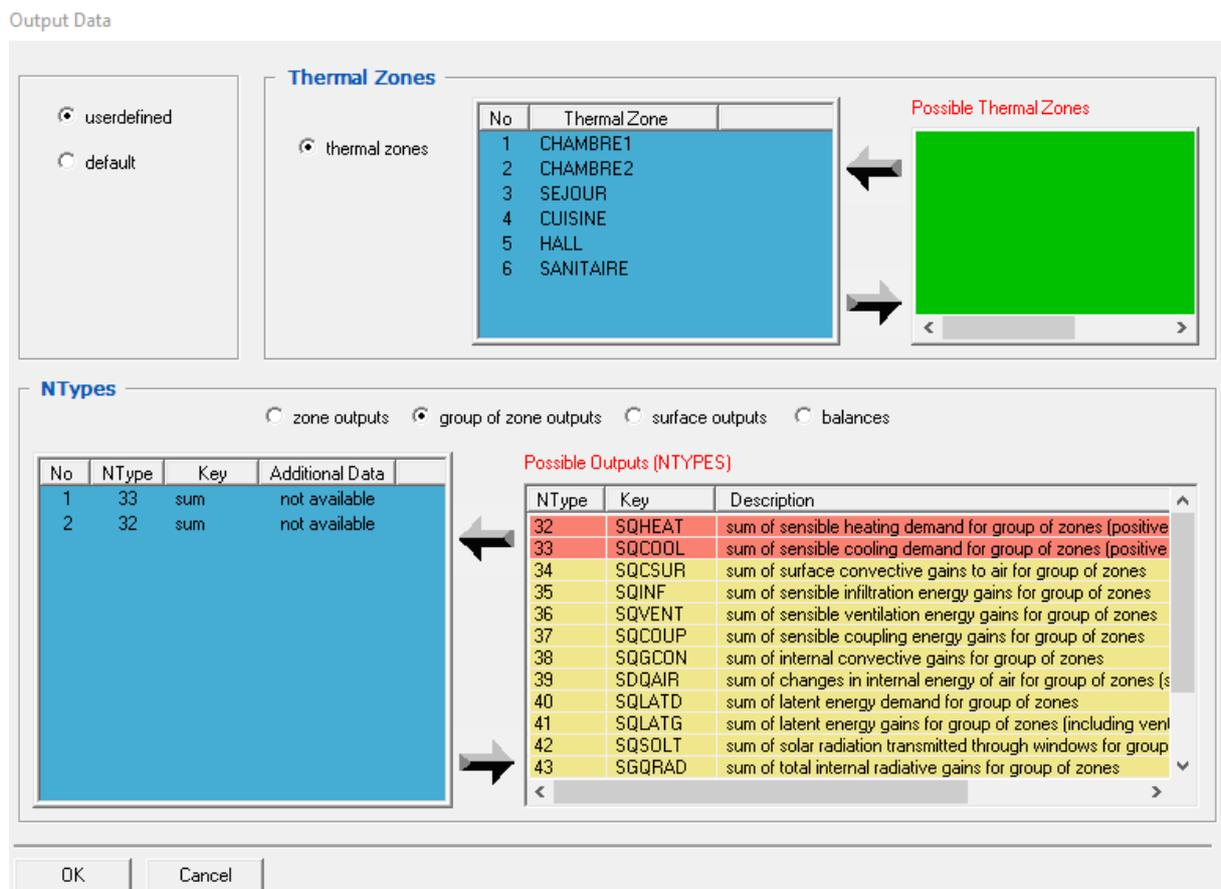
Figure 22: Définitions des outputs pour le calcul des besoins énergétiques.
