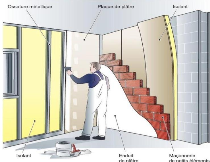
Figure 9: Technique d'isolation des murs par l'intérieur [12].
