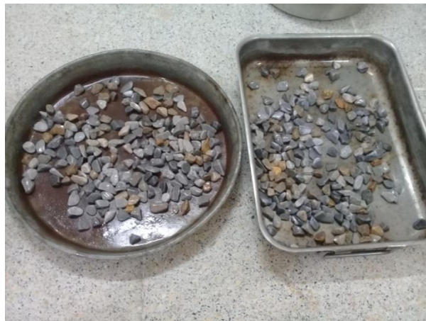
Figure II.9 : L'état de la classe granulaire 10-14 après 1200 rotations.
