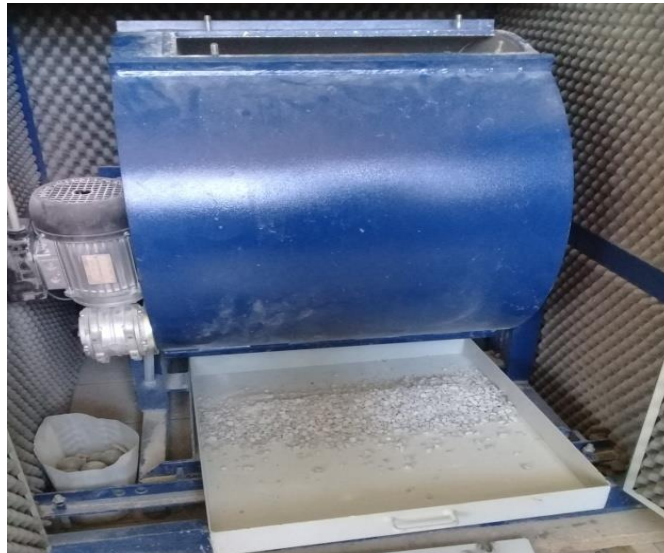
Figure II.7: L'état de la classe granulaire 10-14 après 500 rotations.
