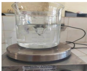
Figure IV.17: Agitation de la solution de l'hydroxyde de sodium.
