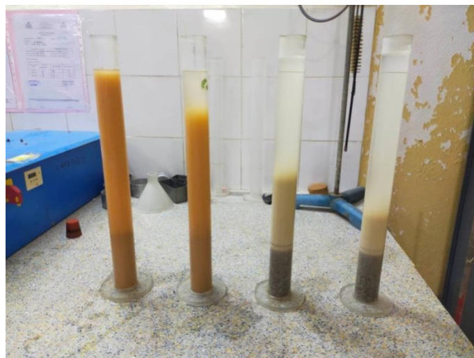
Figure II.10 : Mesure de la hauteur du sable 0/4 et 0/1
