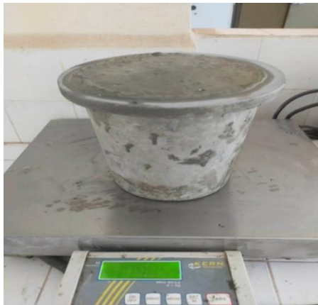
Figure IV.3 : La masse volumique de béton frais.
