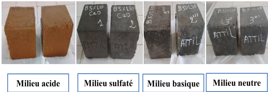
Figure IV.19: Photos des cubes conservés dans différents milieux à 35 jours.
