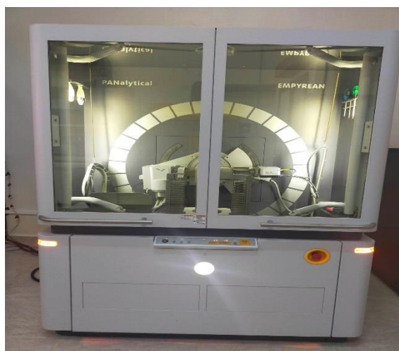
Figure II.16 : Appareil de DRX de CRAPC.
