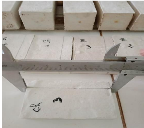
Figure III.13 : Processus de l'essai de retrait.
