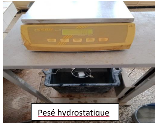
Figure III.14 : Le processus de la pesé hydrostatique.
