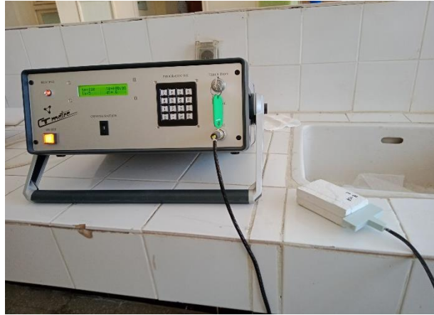
Figure III.12 : L'appareil de CT-mètre muni d'une sonde.
