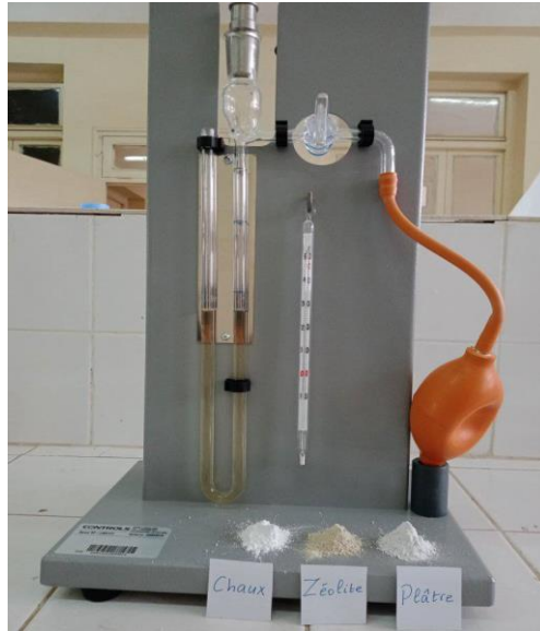
Figure II.5 : L'essai de surface spécifique.
