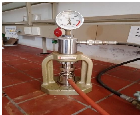
Figure II.12 : système moule + presse pour former une pastille.
