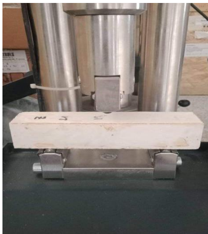
Figure III.9 : Essai de résistance à la flexion.
