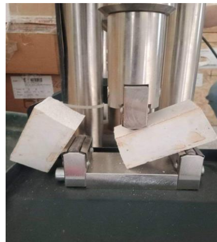
Figure III.9 : Essai de résistance à la flexion.
