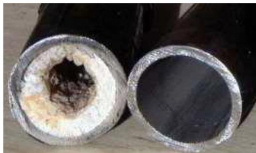
Figure I.1 : Photo de dépôt de tartre de carbonate de calcium dans la canalisation [10]
