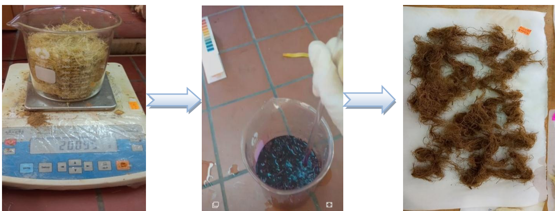
Figure II.7. Etapes de traitement aux permanganates ( KMnO_4 )
