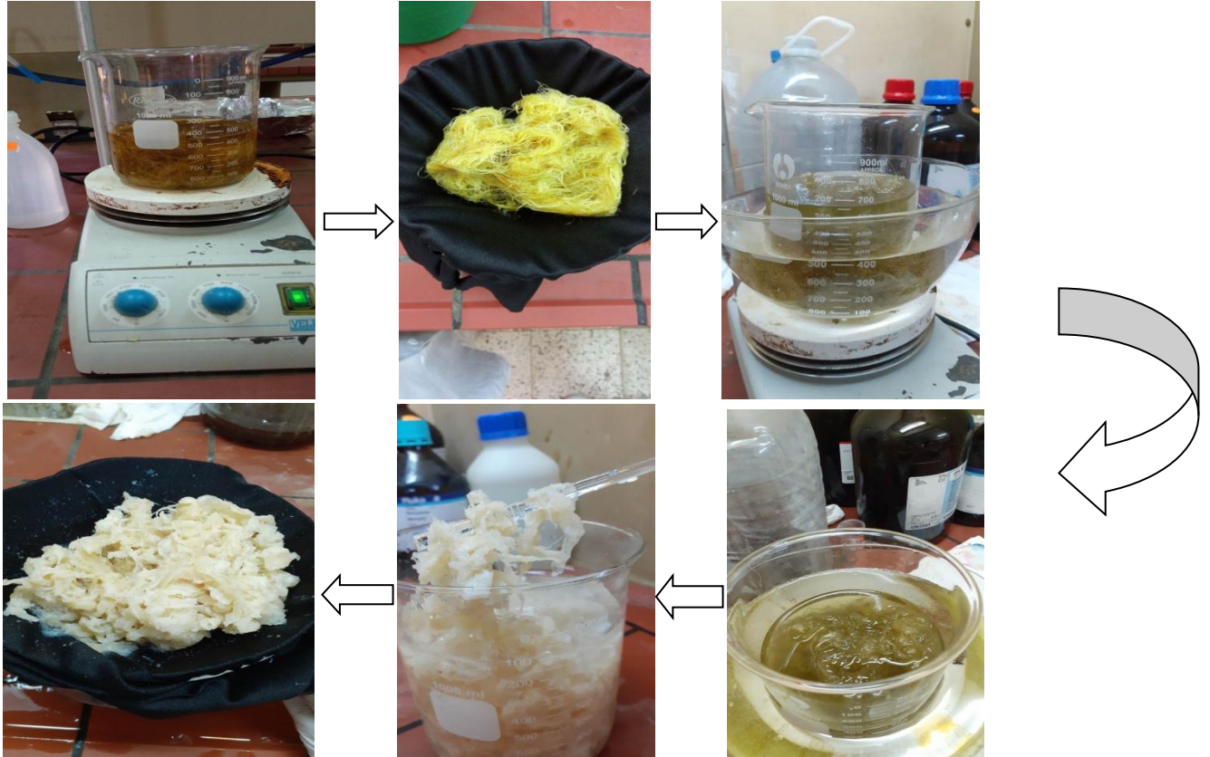
Figure II.8. Etapes de traitement d'acétylation.
