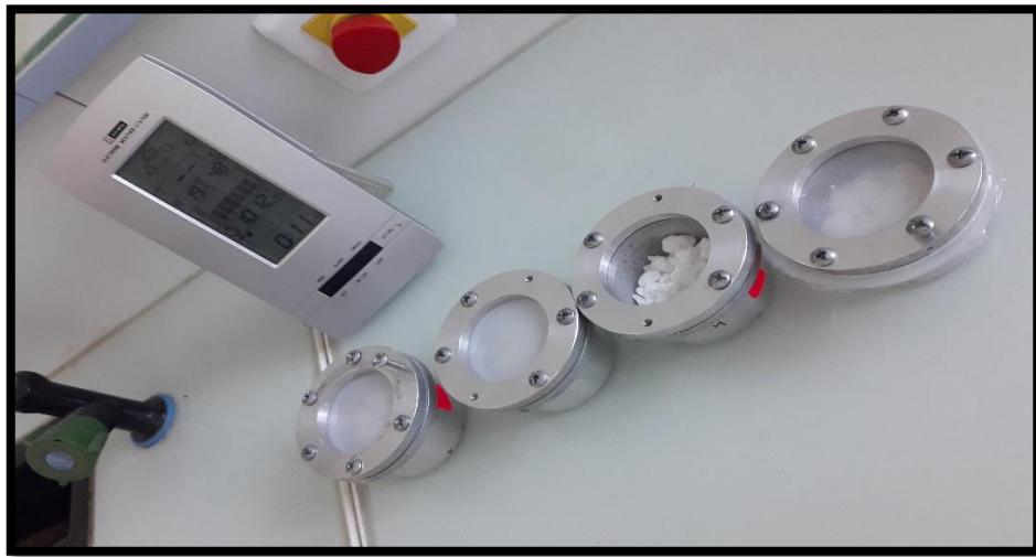
Figure II.8: Test de perméabilité d'eau pour les nanocomposites.
