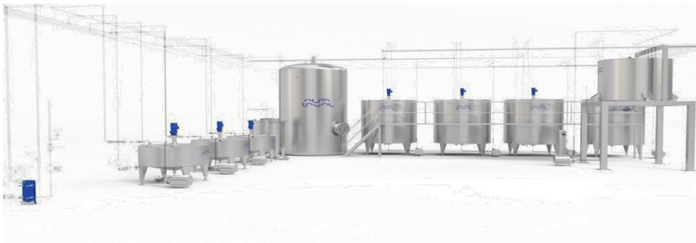
Figure II.4 : Procédé de préparation de la phase aqueuse
