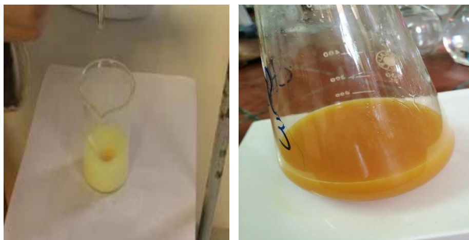
Figure III.15 : Dosage volumétrique des ions chlorure
