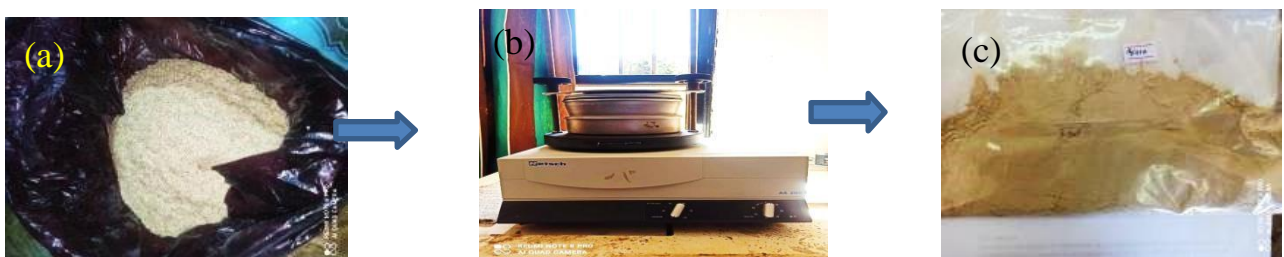
Figure IV.4 Photos montrant : (a) La farine de Genêt d'Espagne, (b) La tamiseuse, (c) La poudre de Genêt d'Espagne
