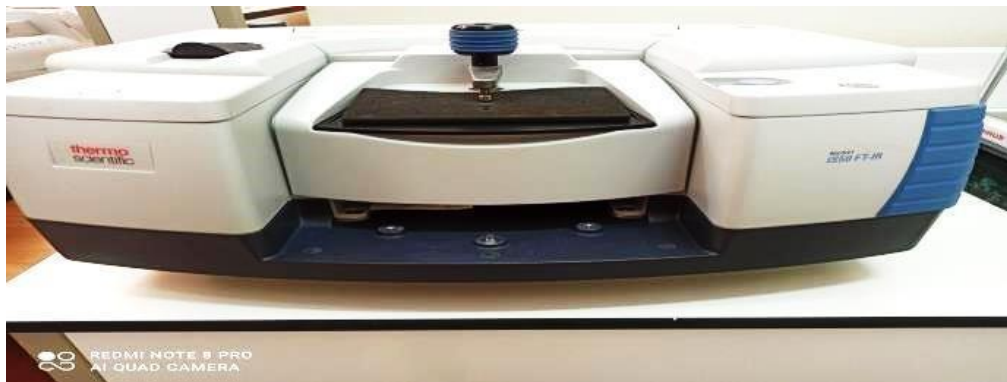
Figure IV.7 Appareil de la spectroscopie infrarouge à transformée de fourier (IRTF) en mode réflectance totale atténuée (RTA)
