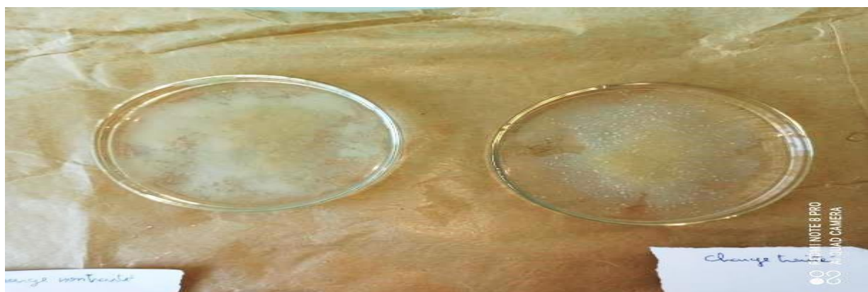
Figure V.3 Image de l'étalement des fibres GE sur l'eau distillée
