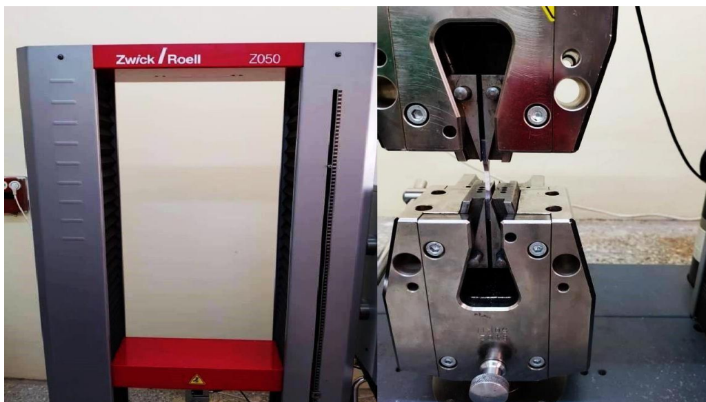
Figure IV.8 Photo de la machine utilisée pour la réalisation de l'essai de traction
