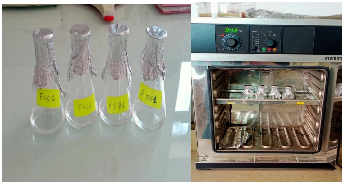
Figure III.8 : Les erlenmeyers contenant de solution avec les films dans une étuve de migration.
