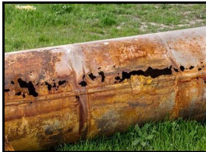
**Figure I.8:** *Exemple de la corrosion sélective* [22].
