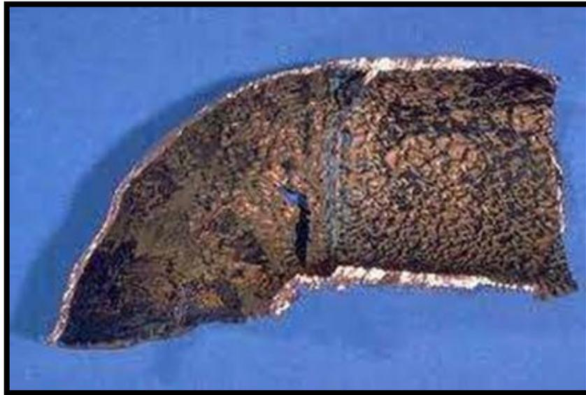
**Figure I.11 :** *corrosion par érosion* [27].
