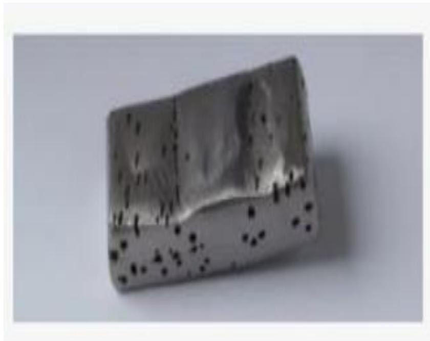
**Figure I.6 :** *Corrosion par piqures* [18].
