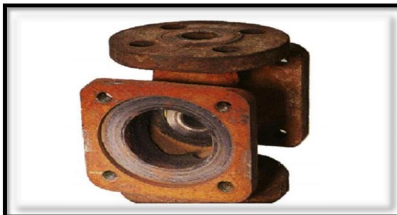
**Figure I.5 :** Corrosion générale (rouille) d'une pièce en acier [14].
