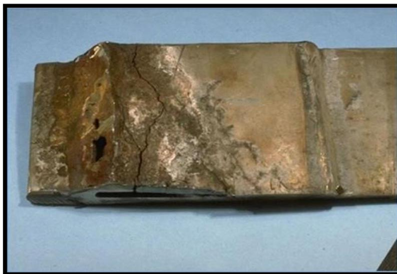
**Figure I.12 :** *Corrosion sous contrainte* [29].
