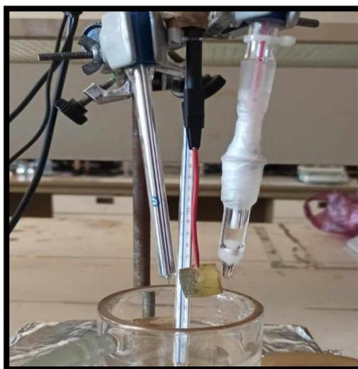
**Figure II.4** : La cellule électrochimique à trois électrodes.
