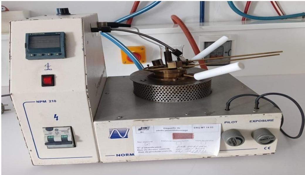
**Figure II.9 Instrument de mesure de point d'éclair.**
