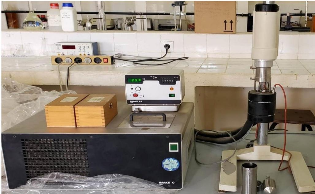
**Figure II.6 : Le viscosimètre de Couette.**
