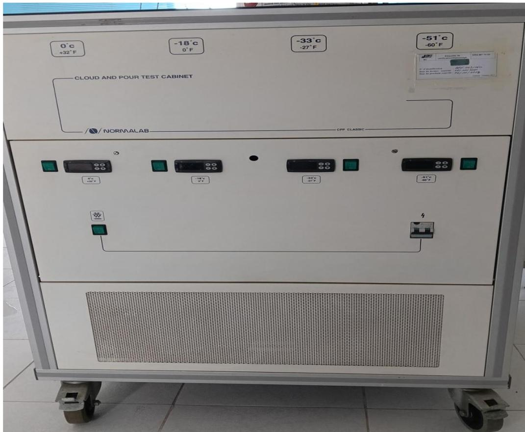
**Figure II.8** Appareil de mesure de point de congélation.
