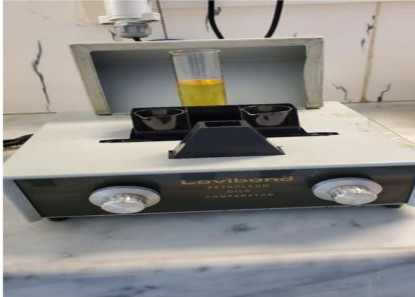
**Figure II.7 Le calorimètre pour mesurer la couleur.**
