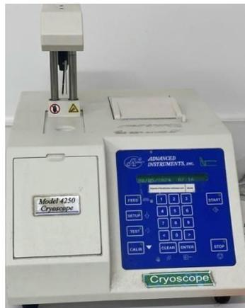
Figure 03. Photographie d'un Cryoscope
