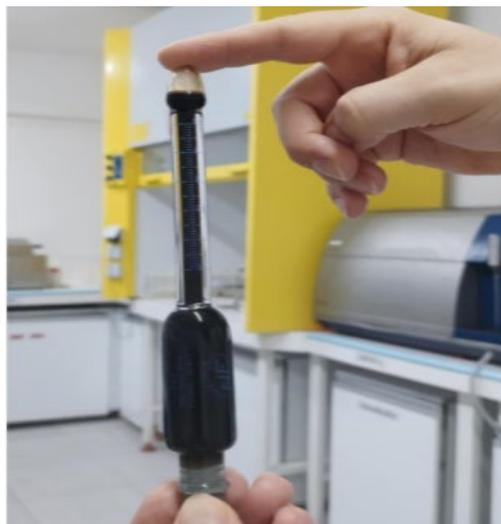
**Figure 10** : Photographie: d'un butyromètre Gerber
