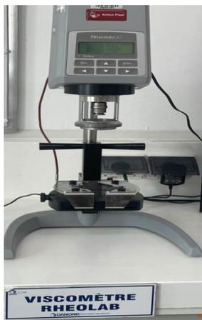
**Figure 08.** Photographie d'un Viscosimètre RHEOLAB
