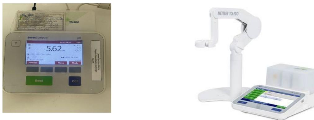
**Figure 01.** Photographie d'un pH- mètre.
