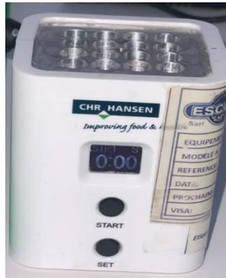
**Figure 04.** Photographie d'un appareil pour test d'antibiotiques dans le lait « MilkSafe 3BTC »
