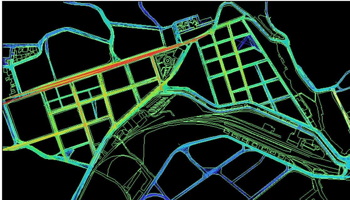
Figure 20 : Carte syntaxique du quartier de Lekhmis, obtenue à partir du test effectué par le logiciel Depthmap 0.3.
