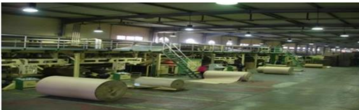
Figure N°07 : Arrivage des bobines de papier devant l'onduleuse General Emballage
