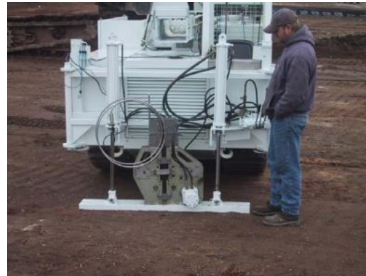
Figure 7: Ramet portable pour CPT à l'intérieur des bâtiments
