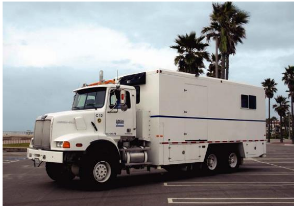
Figure 6: Unité CPT de 25 tonnes montée
