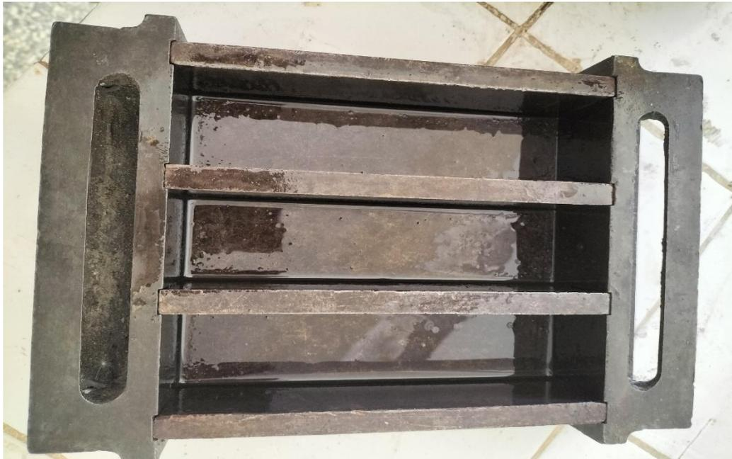
**Figure II.9.** Moule d'utilisation pour la matrice cimentaire de dimension 4\*4\*16.
