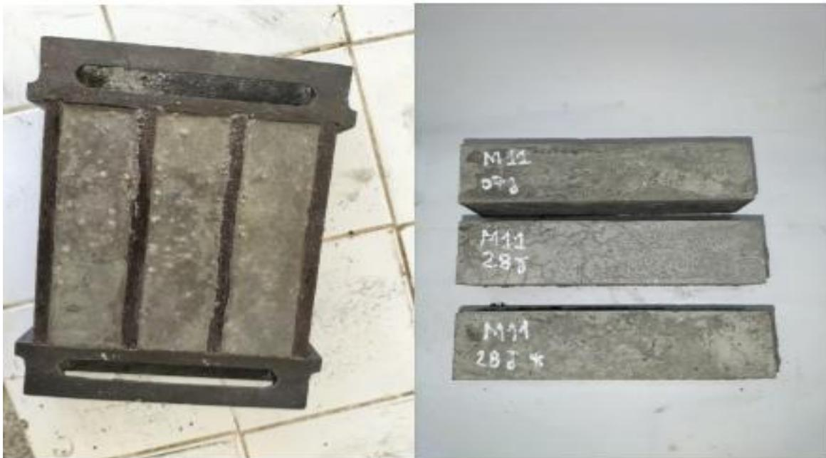
**Figure II.15.** Décoffrage des éprouvettes, dimensions :  $4 \times 4 \times 16 \text{ cm}^3$
