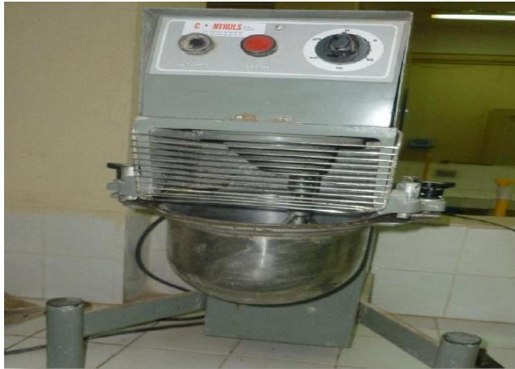
**Figure II.11.** Malaxeur utilisé pour la préparation du mortier
