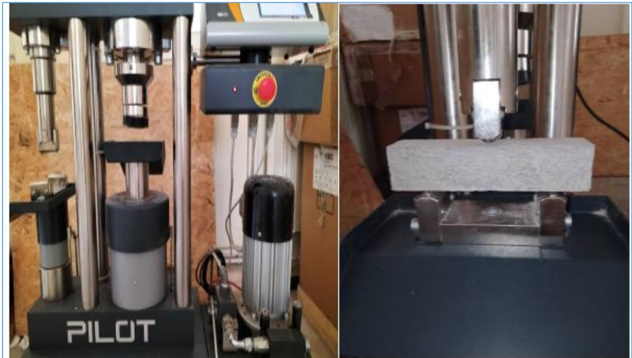
**Figure II.20.** Machine de tests de flexion CONTROLS
