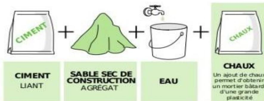
Figure I.4. Composition de mortier
