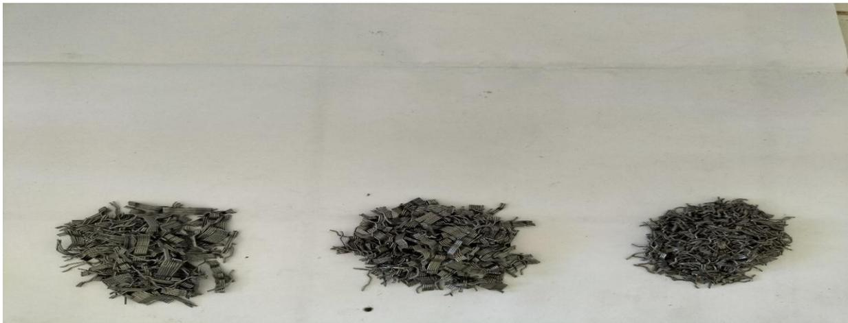
**Figure II.8.** Photo des fibres métalliques utilisées dans le mortier.
