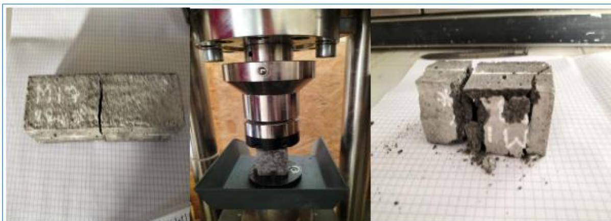
**Figure II.23.** Éprouvette de mortier vierge avant et après le test de compression.
