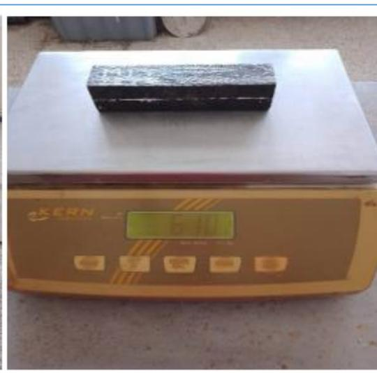
**Figure II.17.** Pesé hydrostatique sous l'eau    **figure II.18.** Pesé hydrostatique à l'Etat saturé
