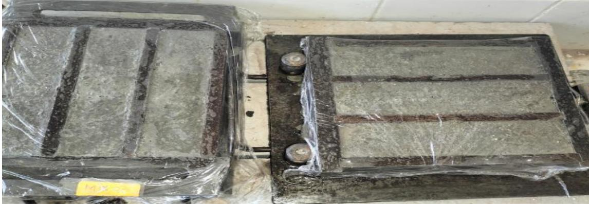
**Figure II.14.** Moule couvert avec du film plastique.
