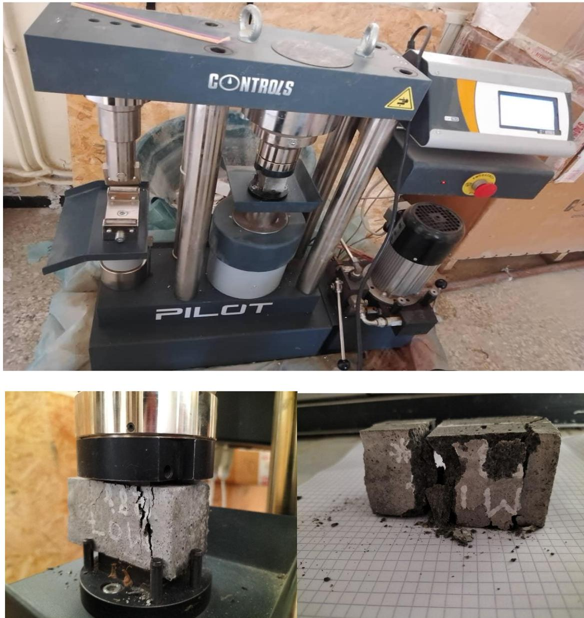
**Figure III.10.** Essai de compression
