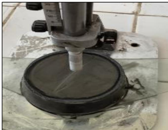
**Figure II.4.** Essai de consistance du ciment utilisé
