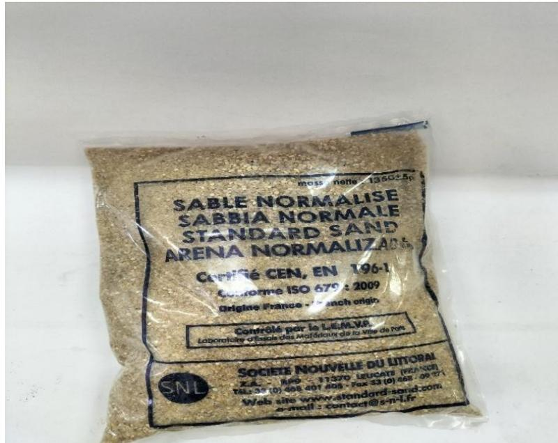
**Figure II.6.** Photo du sac de sable normalisé selon la norme EN 196-1
