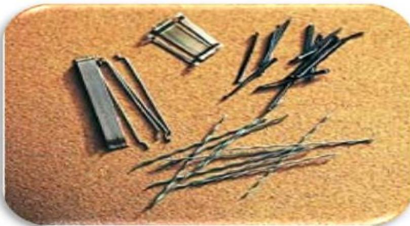
**Figure I.10.** Différents types de fibres métalliques
