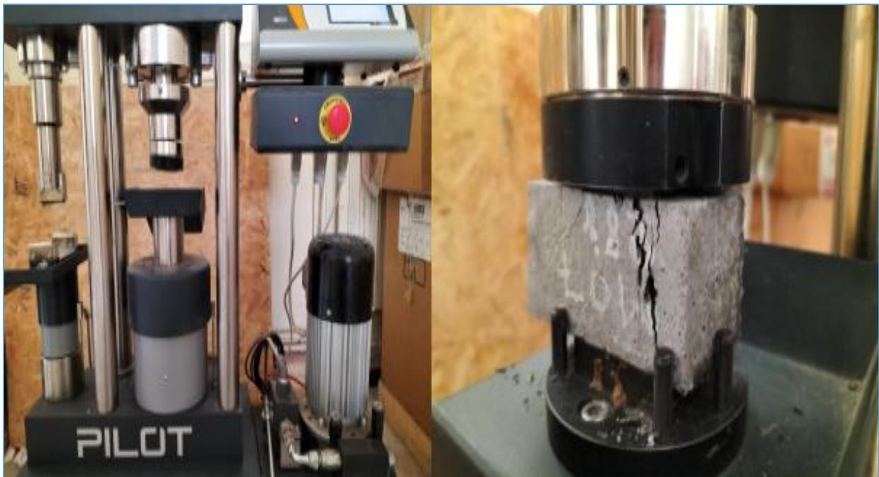
**Figure II.22.** Eprouvette soumis aux tests de compression
