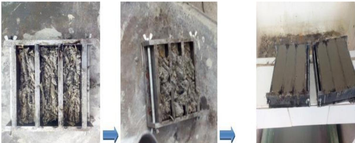
**Figure II.12.** Fabrication et moulage des éprouvettes
