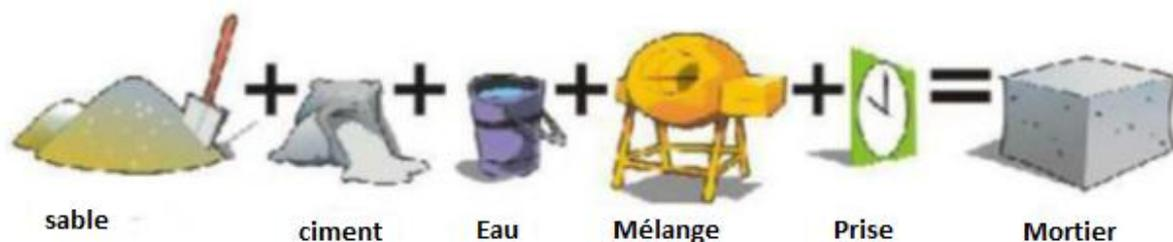
Figure I.3. Constituants et fabrication des mortiers
