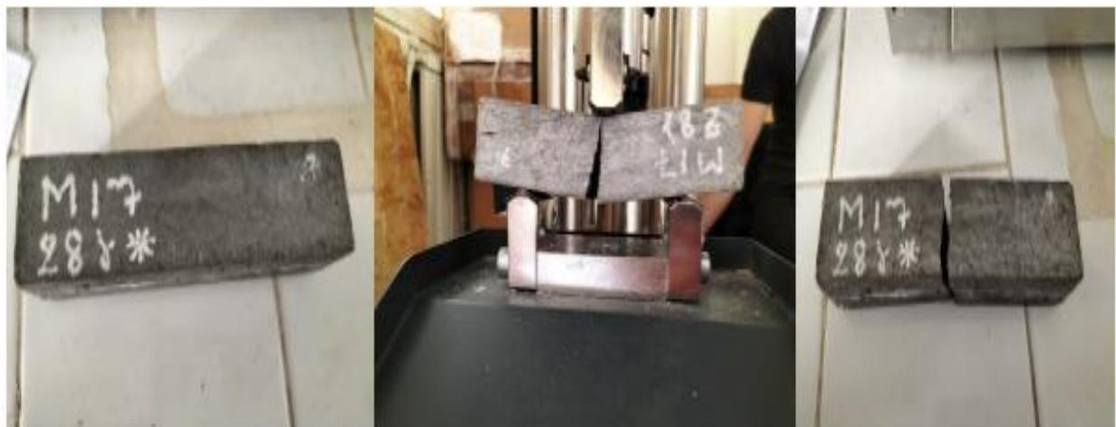
**Figure II. 21.** Eprouvette de mortier avant et après le teste de flexion
