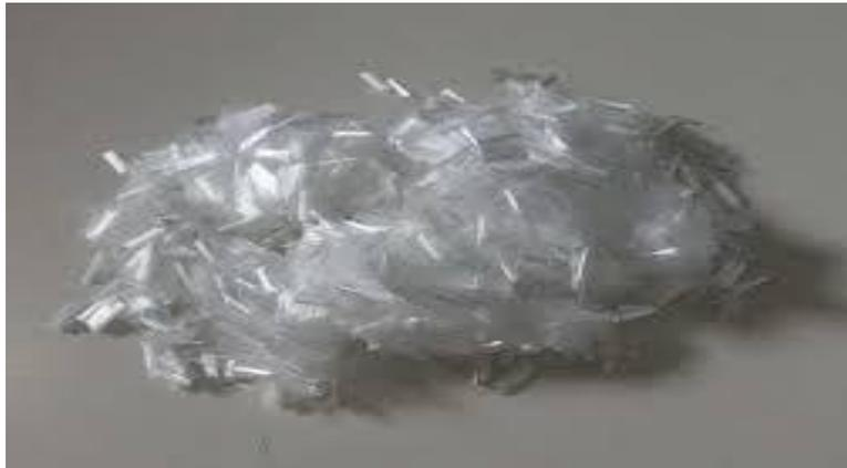
**Figure I.15.** Fibre de polypropylène
