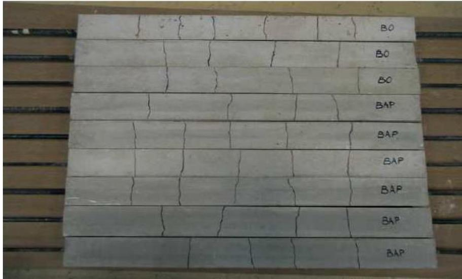
**Figure II.15.** Tirants réalisés par Daoud avec différents diamètres et différents type du béton.
