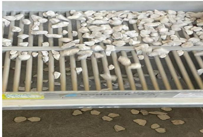
**Figure II.4** : Grille à fente utilisé pour l'essai d'aplatissement.
