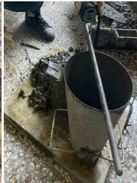
**Figure IV.6** : Affaissement du béton avec poudre de verre à 25%.
