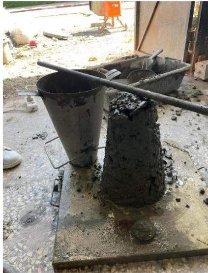
**Figure IV.3** : Consistance du béton avec poudre de verre à 10%.
