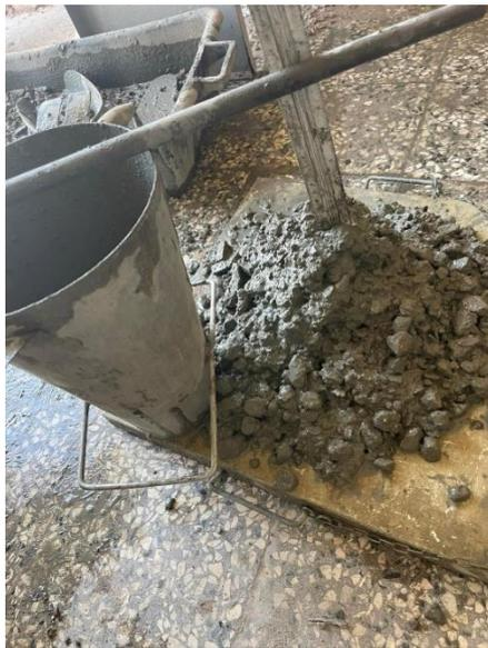
**Figure IV.5** : Affaissement du béton avec poudre de verre à 20%.
