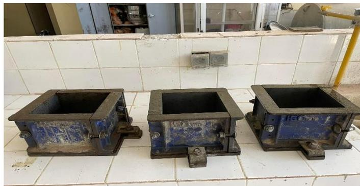
**Figure III.4** : les moules à béton cubiques 15x15x15 cm<sup>3</sup>.
