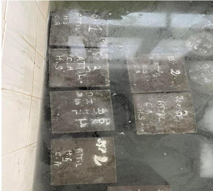
Figure IV. 9 : Conservation des éprouvettes du béton dans l'eau.
