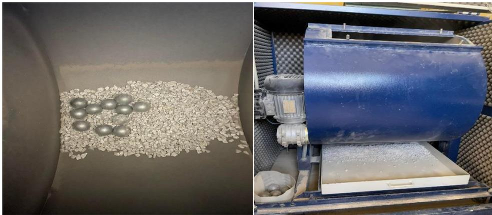
**Figure II.7** : L'essai Los Angeles.
