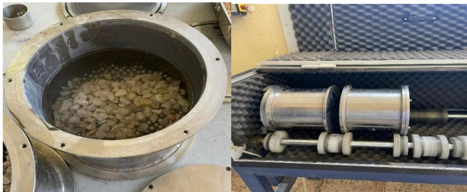
**Figure II.8** : L'essai de Micro-Deval.
