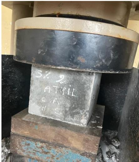
**Figure IV.11 :** Eprouvette de béton pendant l'écrasement.
