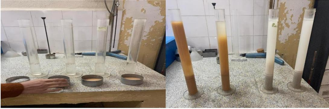
**Figure II.5 :** L'essai d'équivalent de sable.
