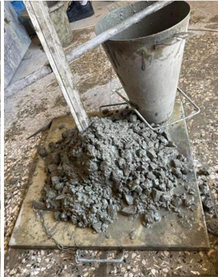
**Figure IV.4** : Affaissement du béton avec poudre de verre à 15%.
