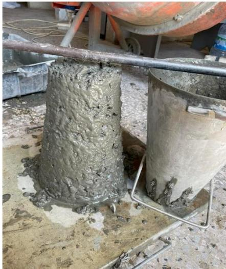
**Figure IV.1** : Consistance du béton témoin.
