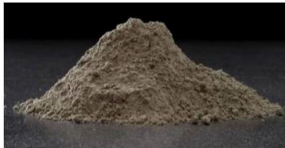
**Figure I.8** : Le ciment, un liant hydraulique.
