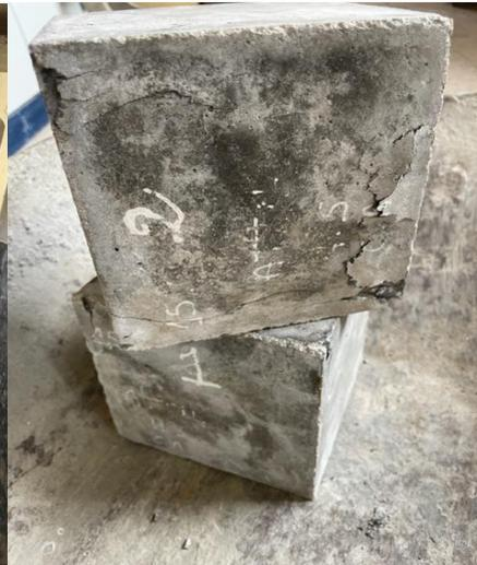
**Figure IV.12 :** Eprouvette de béton après l'écrasement.
