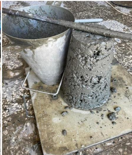
**Figure IV.2** : Consistance du béton avec poudre de verre à 5%.
