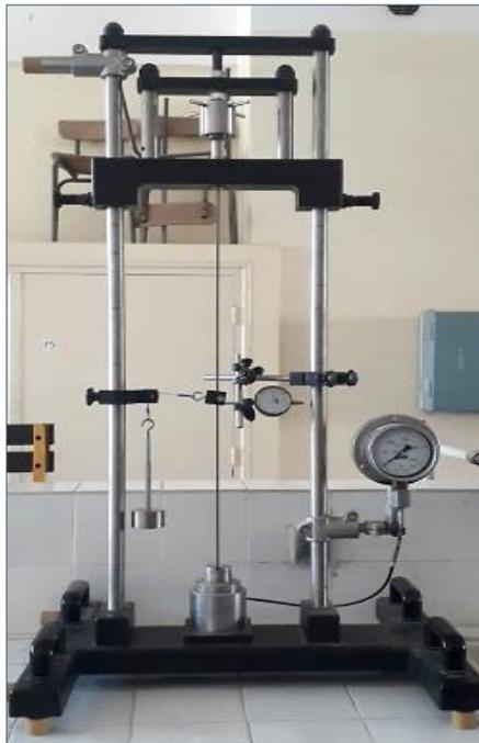
Figure III-16 : Barre bi-articulée avec une charge transversale.
