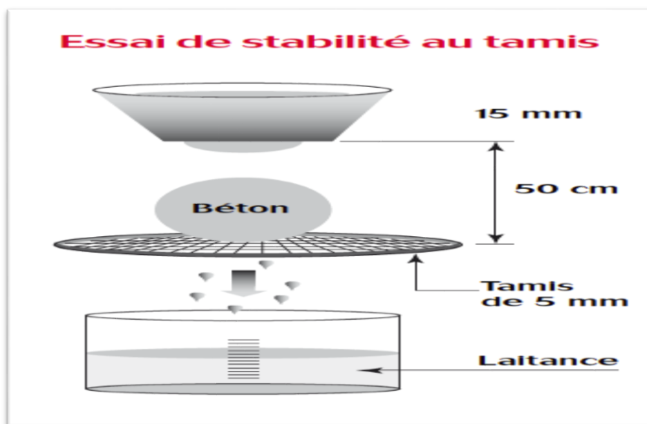
Figure. III.8 : Principe de l'essai de stabilité au tamis.
