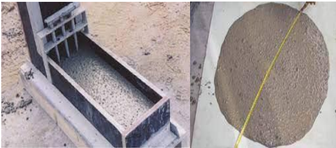
Figure I.7 : Différents essais de caractérisation des bétons auto-plaçants
