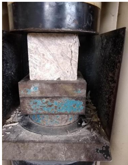
Figure IV.12 : Ecrasement du béton auto-plaçant avec ajout fines de déchets de brique.
