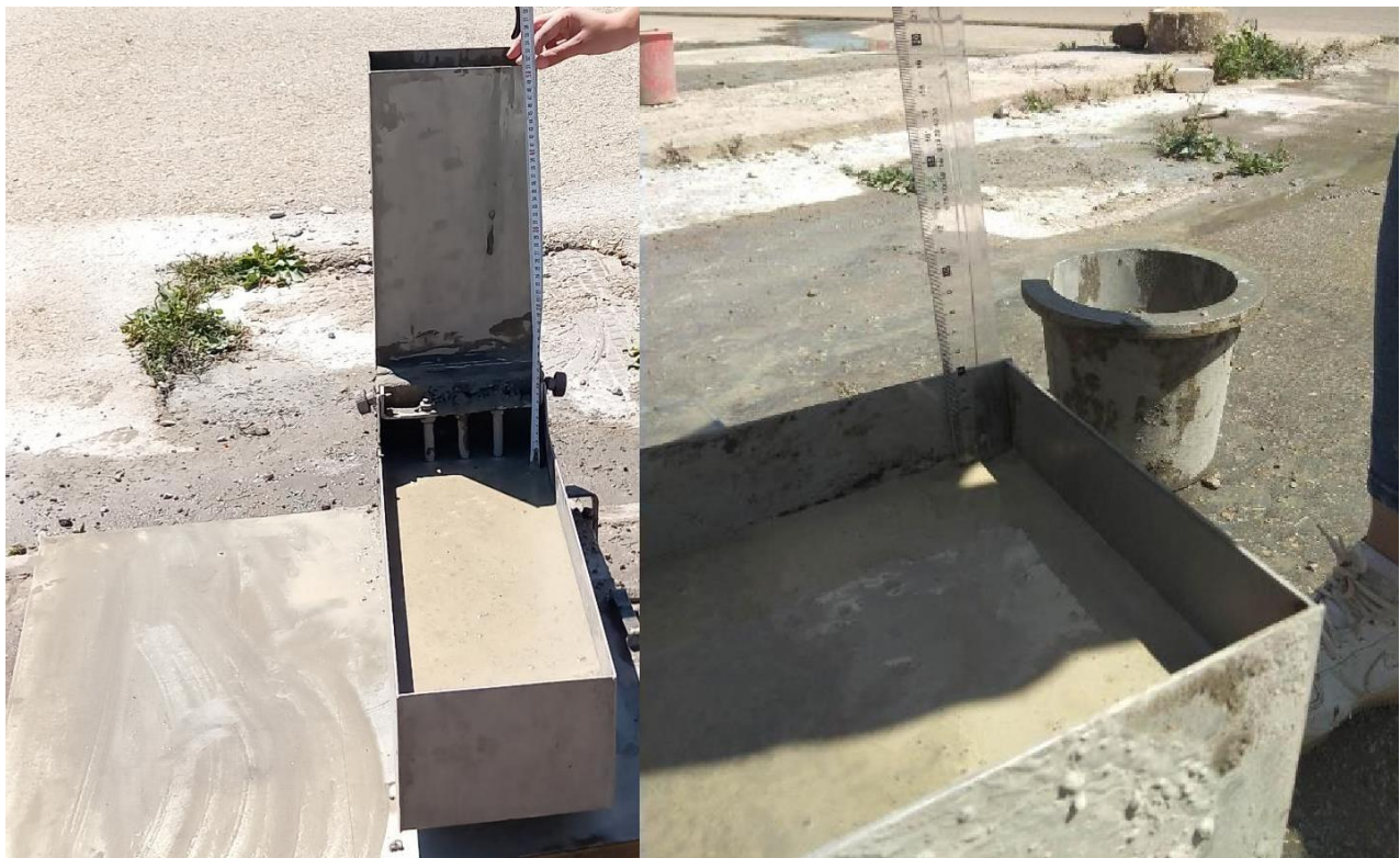
Figure IV.8 : Essai de la boîte en L pour le BAP avec de fines de fumée de silice.
