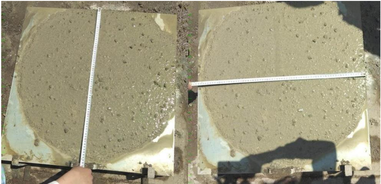
Figure IV.3 : Essai d'étalement pour le BAP avec fines de laitier.
