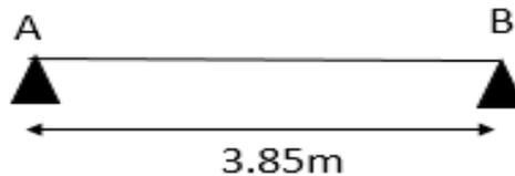
**Figure III 2 schéma statique de la poutrelle type 5**
