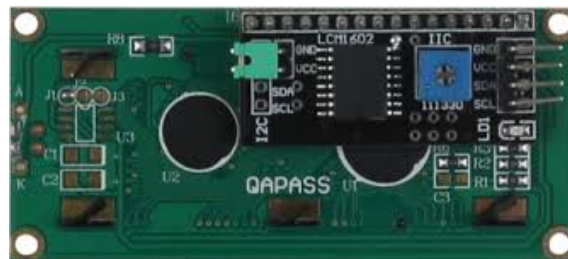
FIGURE 4.1 – Le montage de l'écran LCD avec son adaptateur I2C
