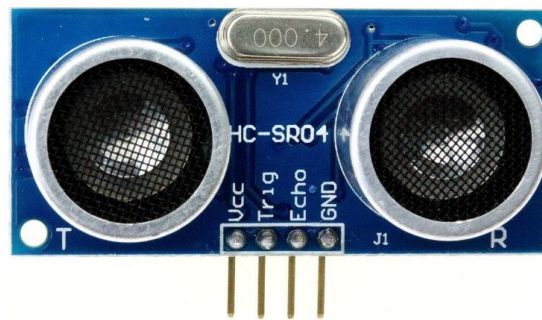
FIGURE 3.10 – Le capteur de distance ultrasonique HC-SR04 [65]
