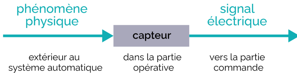
FIGURE 3.3 – Le fonctionnement d'un capteur
