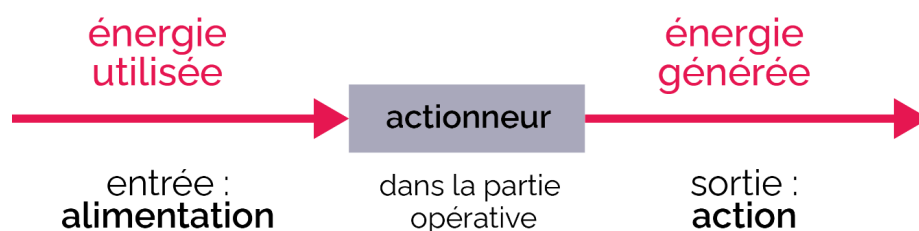
FIGURE 3.4 – Le fonctionnement d'un actionneur
