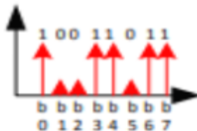
Figure I.8 : Signal d'échantillonnage fourni par un capteur numérique.
