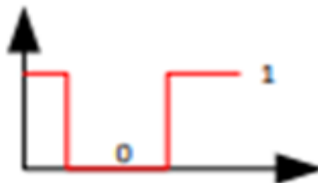
Figure I.6 : Signal de sortie du capteur TOR.
