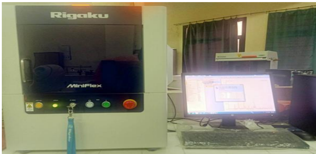
Figure II.9. Diffractomètre de rayons X de type Rigaku Mini flex-II diffractomètre (Laboratoire de physique des matériaux et catalyse, Université de Bejaia)
