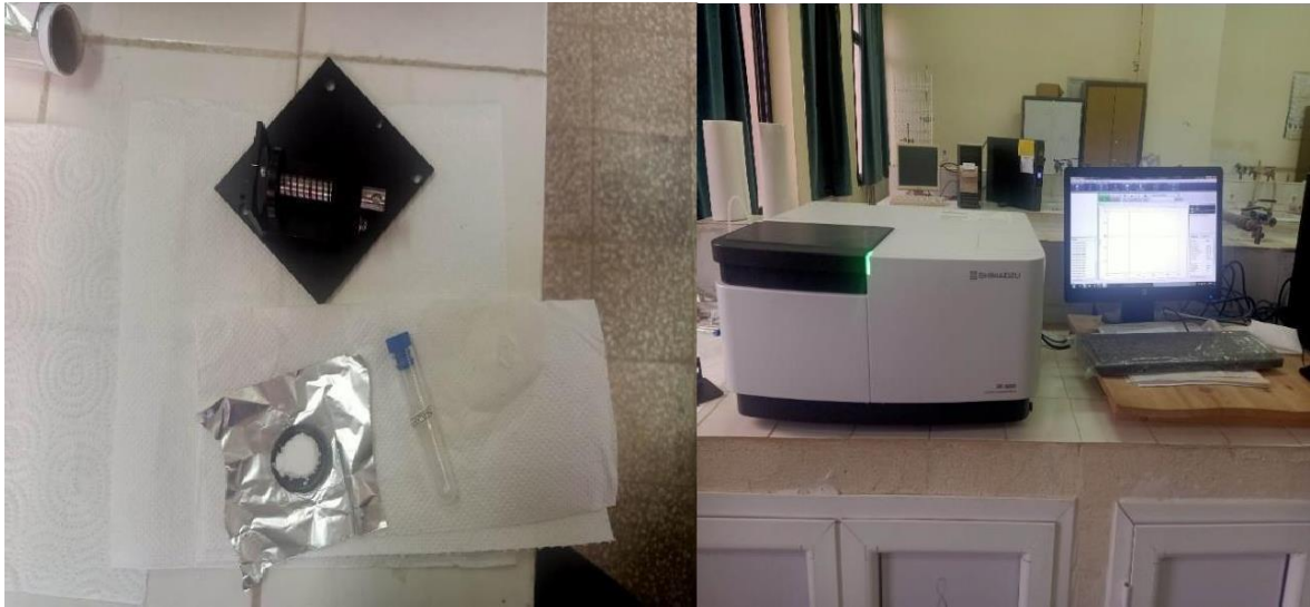
Figure II.12. Spectromètre de photoluminescence Shimadzu RF-6000 (Laboratoire de physique des matériaux et catalyse, Université de Bejaia)
