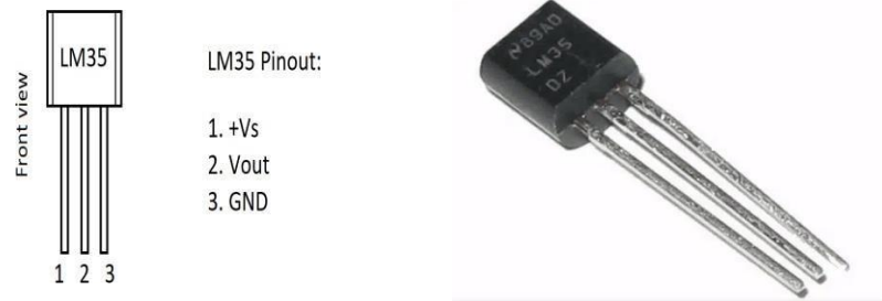
Figure I. 2 Présentation du capteur de température LM35
