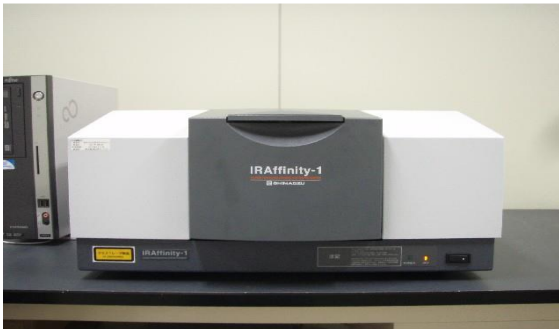
Figure 23: L'appareil IRAffinity-1 utilisé pour l'analyse IRTF.
