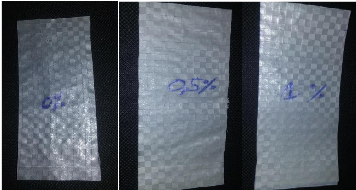
(a)Film à 0% du pro-oxydant. (b) Film à 0.5% du pro-oxydant. (c)Film à 1% du pro-oxydant.
